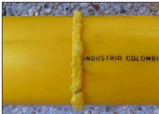
FIGURA 6. Abundante burbujeo en una unión servicio – servicio expuesta a mil horas de inmersión.
