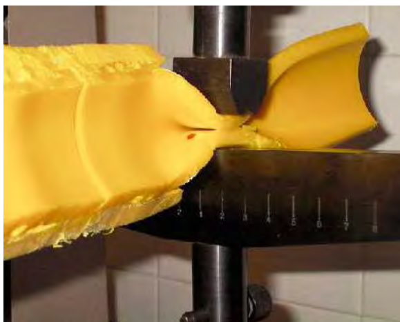
Figura 11. Ensayo de decohesión sobre una unión por electrofusión en tubería de 3 pulgadas PE 80.
