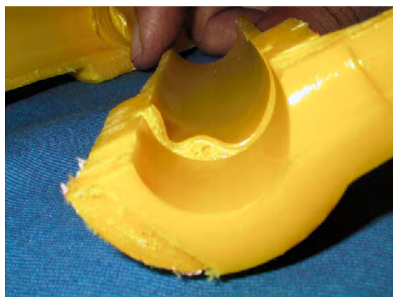
Figura 12. Sección transversal de una unión por termofusión a socket a partir de una TEE ¾ * ½ pulgada IPS.
