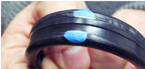
Figura 15 Ensayo de doblamiento sobre el reborde externo de la termofusión de una tubería de 315 mm de diámetro, que contiene 5% de talco.
