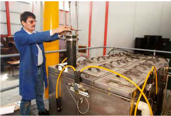
Figura 1 equipo para el ensayo de ruptura de tubo completo
