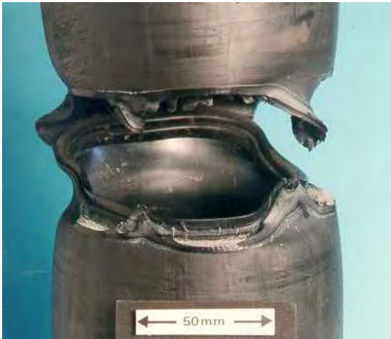
Fig. 7 Falla externa por el reborde termofundido en tubería de 125 mm de diámetro.
