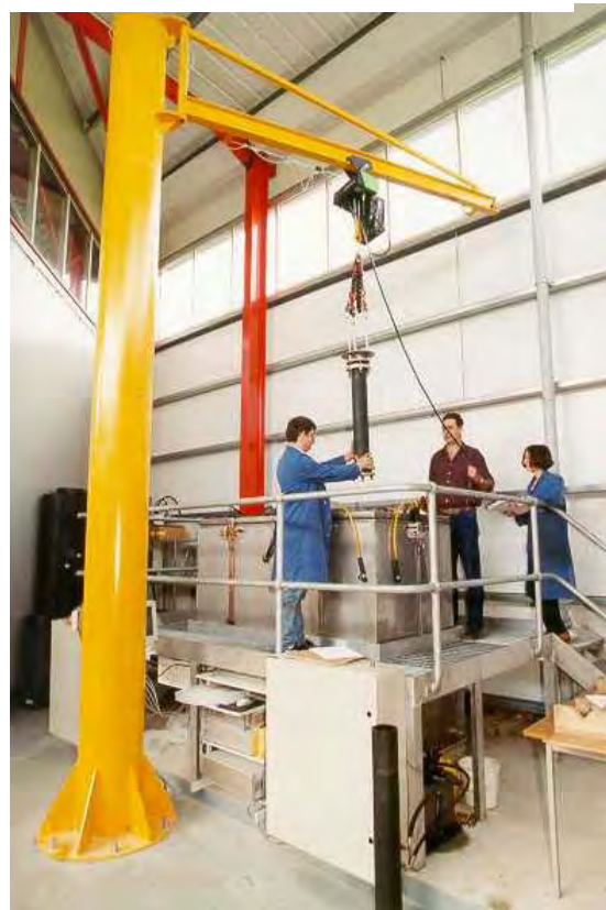
Figura 2 parte superior de equipo de ruptura de tubo completo
