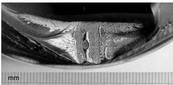
Fig. 17 Fotografía del área de iniciación de la falla en una termofusión, en una tubería de 125 mm de diámetro que contiene un defecto planar de 2 mm de diámetro.
